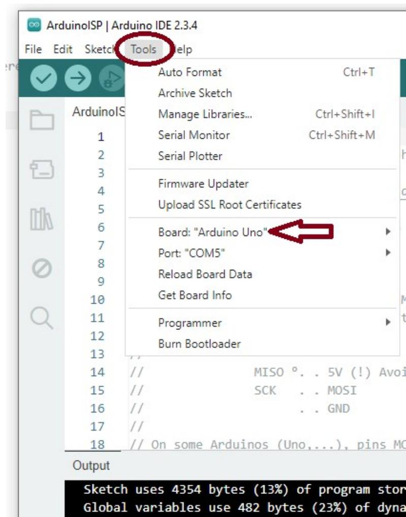
5 – Clique na opção Programmer (Gravador) e em seguida em Arduino as ISP
