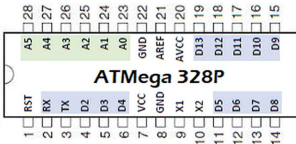
A cronologia dos pinos (1 ao 28), corresponde exatamente as funções que são identificadas no Arduino UNO (Entradas/saídas digitais, Rx / Tx, Reset, Entradas analógicas, etc.)
